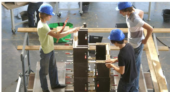
iii. 12 (haut) : Tour de sable compacté armé. Les murs ont une épaisseur de 4 cm pour une tour de 3 mètres de haut. Sur l'image de droite, la surface a été frottée pour laisser apparaître des armatures placées entre les couches de sable .
