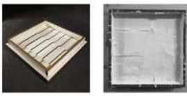
Fig.4 - Coffrage à matrice en carton bois et fond de coffrage positif en pas de trame 40.
