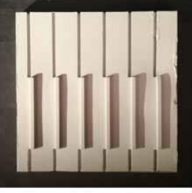
Fig.6 - Matrice silicone reproduisant le négatif de notre motif.
