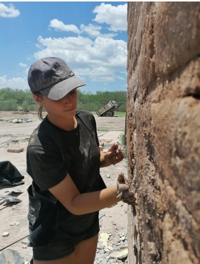
> Tests d'enduit terre sur mur d'adobes
